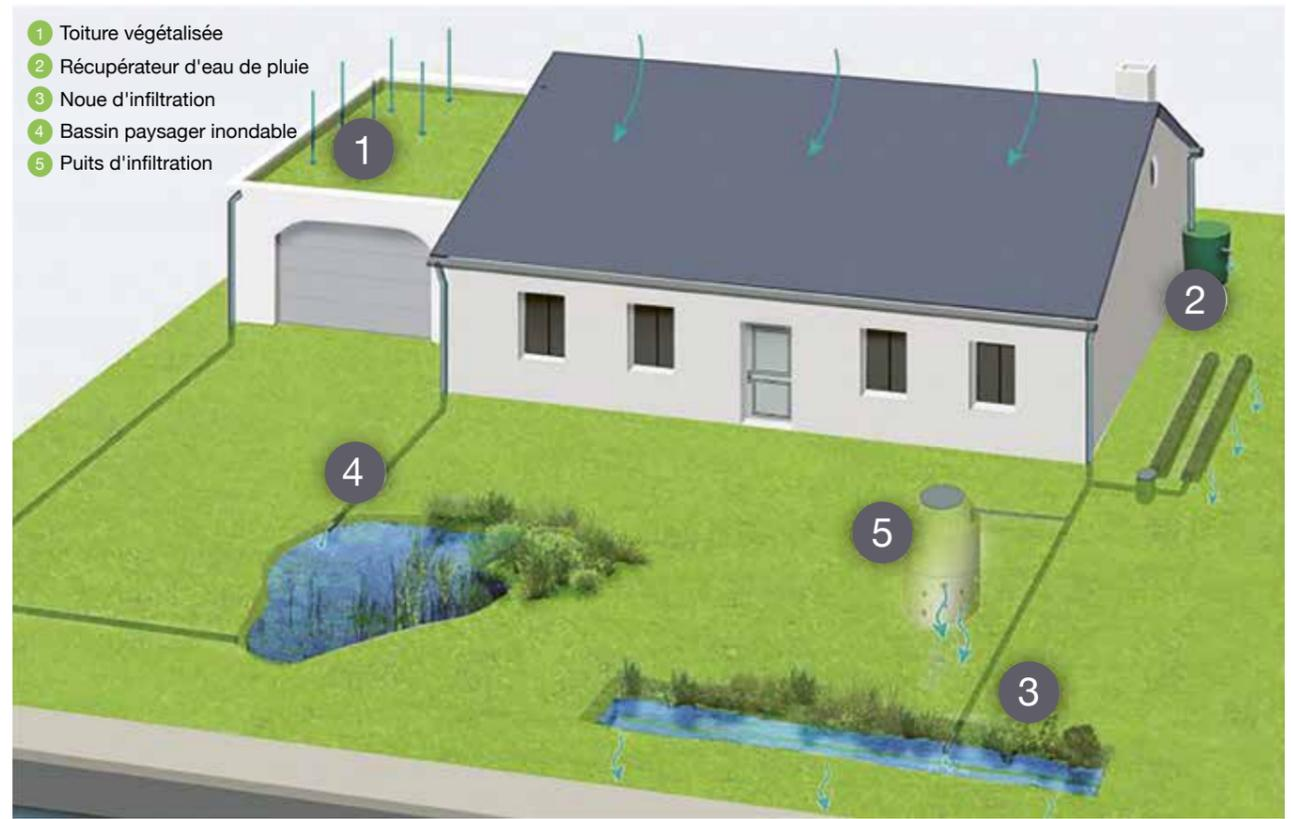
Traiter l'eau de pluie au plus près de là où elle tombe permet d'éviter les rejets dans les réseaux d'eaux pluviales publics qui peuvent vite être saturés en cas de fortes précipitations. Surtout, dans les zones urbaines où les surfaces naturelles qui permettent d'infiltrer l'eau sont trop peu nombreuses.
